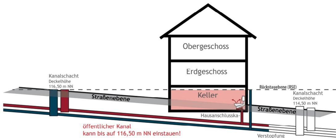
In diesem Beispiel wird die Höhe der Rückstauenebene durch die Höhe des bergauf liegenden Kanalschachtes definiert, d.h. dies ist die erste Stelle, an der das Wasser aus dem Kanalnetz auf die Geländeoberfläche austreten kann. Die maßgebende Höhe kann aber auch durch einen an den Kanal angeschlossenen Straßeneinlauf definiert werden, wenn dieser zwischen Anschlussstelle und dem oberhalb liegendem Schacht liegt.
