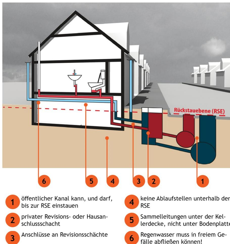
Für Gebäude ohne Keller stellt diese Situation in den meisten Fällen den Normalfall dar. Ein Rückstauschutz wird bei diesen Gebäuden erst dann erforderlich, wenn der Erdgeschossfußboden unterhalb der Rückstauenebene liegt.
