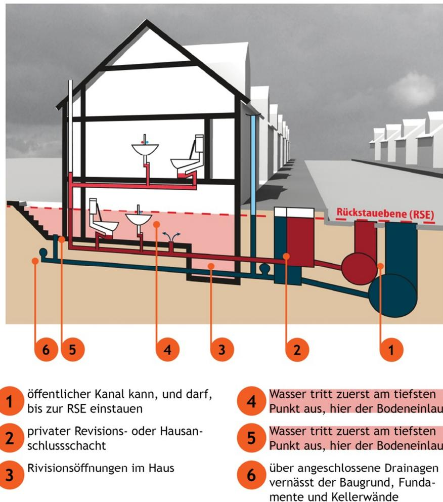
Bei hoher Auslastung des öffentlichen Kanals steigt der Wasserspiegel im Kanalrohr bis über die Höhe des Kellerfußbodens. Wenn es jetzt ungesicherte Abläufe oder undichte Stellen in den Rohren gibt, tritt das Wasser in großen Mengen im Keller aus. Wir haben ausgebaute Keller gesehen, bei denen das Abwasser bis 10 cm unter der Kellerdecke stand.
